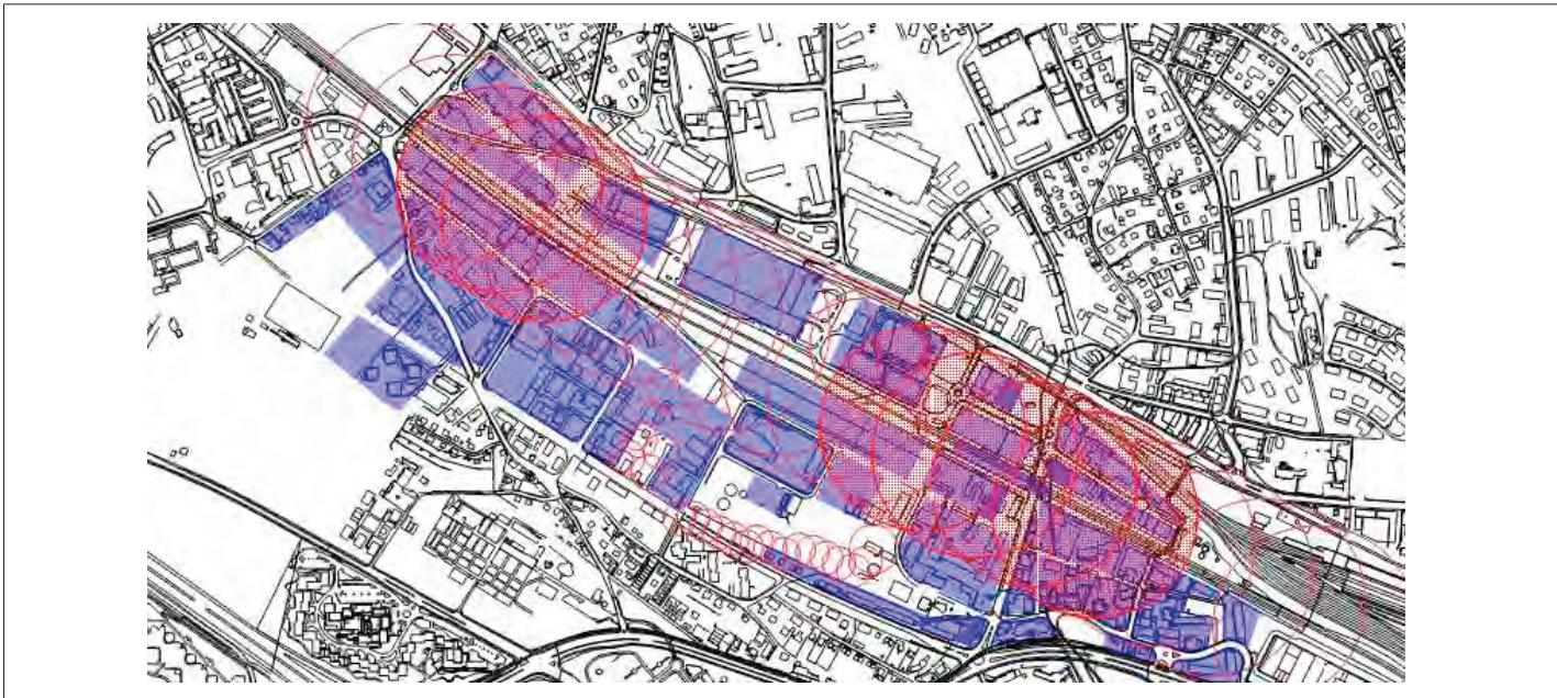
Figur 1: Entwicklungsgebiet Lausanne-West mit Konfliktzonen. Die Konfliktzonen gehen von der SBB-Linie mit Gefahrguttransport aus und liegen dort, wo die geplante Besiedlungsdichte zu hoch ist.
